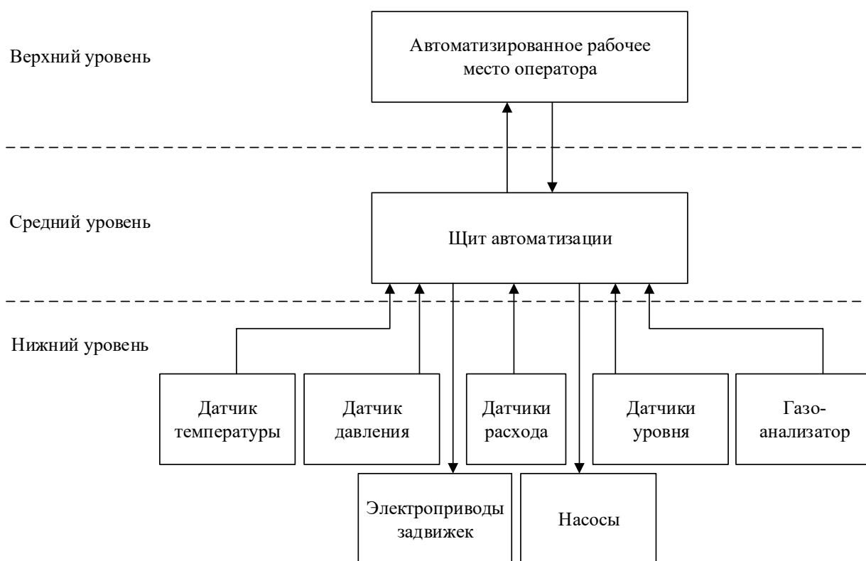
Рисунок 5.1 – Структурная схема автоматизированной системы управления процессом подготовки композиционного жидкого топлива к сжиганию в топке котла
