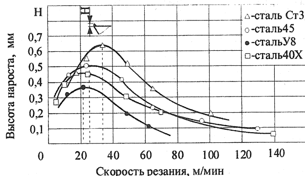
Рис.3. Зависимость высоты нароста от скорости резания: a = 0,2 мм, b = 2 мм
