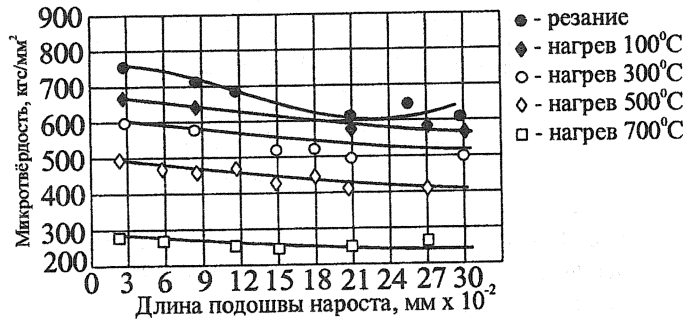
Рис.8. Зависимость микротвердости подошвы нароста от температуры отжига
