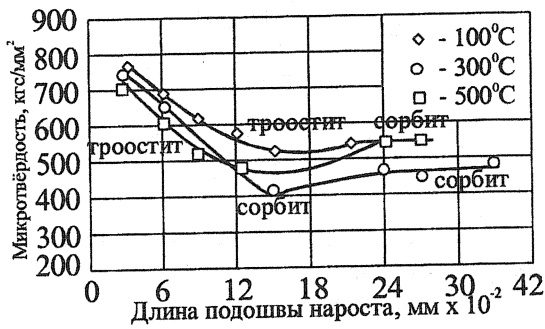
Рис.7. Температурные зависимости микротвердости по длине подошвы нароста при резании стали У8: V = 0,02 мм, b = 2 мм
