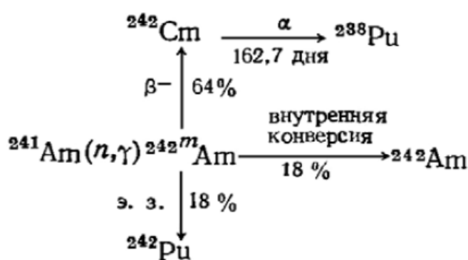
Рисунок 2.1 – Из ^{241}\text{Pu} образовавшегося в ходе облучения нейтронами урана путём \beta -распада образуется ^{241}\text{Am} , который в свою очередь вступает в реакции с нейтронами, образуя ^{238}\text{Pu} и ^{242}\text{Pu}
