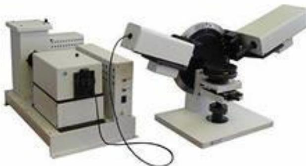
Рисунок 2.5 - Общий вид эллипсометра «Эллипс-1891»
