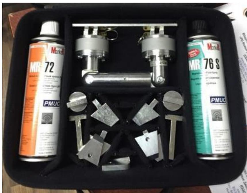
Рис 1.5 Внешний вид дефектоскоп МД-7
