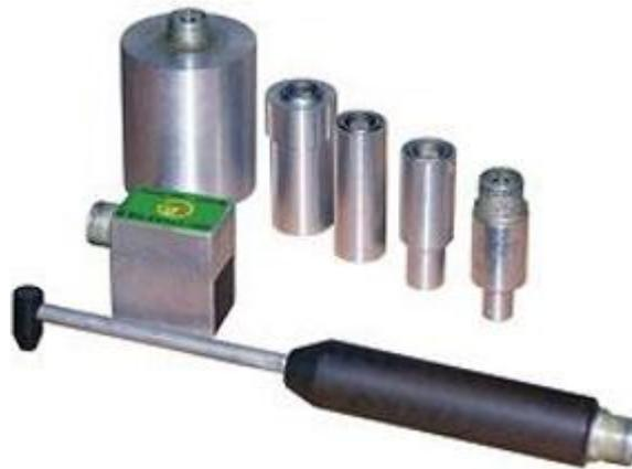
Рис. 2.3. ВТ преобразователи к дефектоскопу
