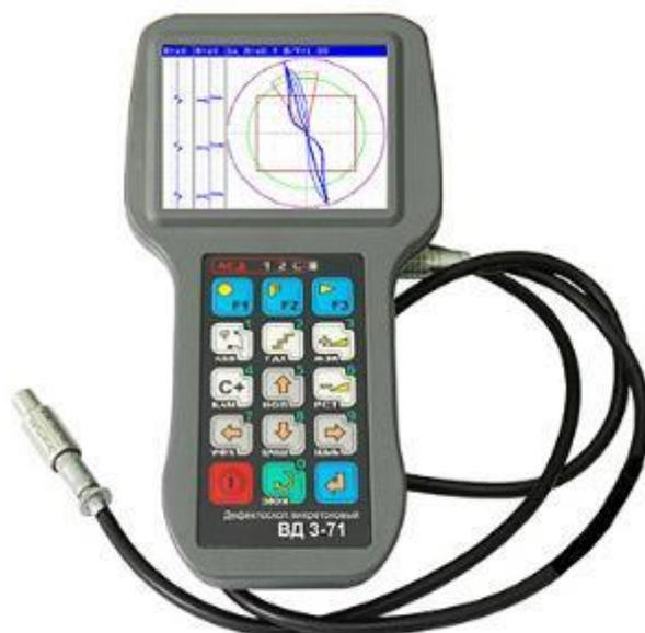
Рис 1.12 Внешний вид дефектоскопа ВД3-71
