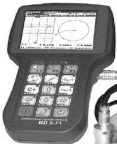
Рис. 2.2. Вихретоковый дефектоскоп ВДЗ-71
