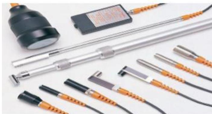
Рис.2.5. ВТП для толщиномеров покрытий
