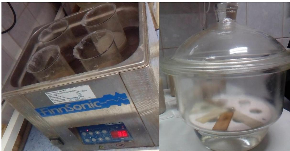
Обработка суспензии в ультразвуковой ванне      Насыщение образца парами органической жидкости (этиленгликогеля)
