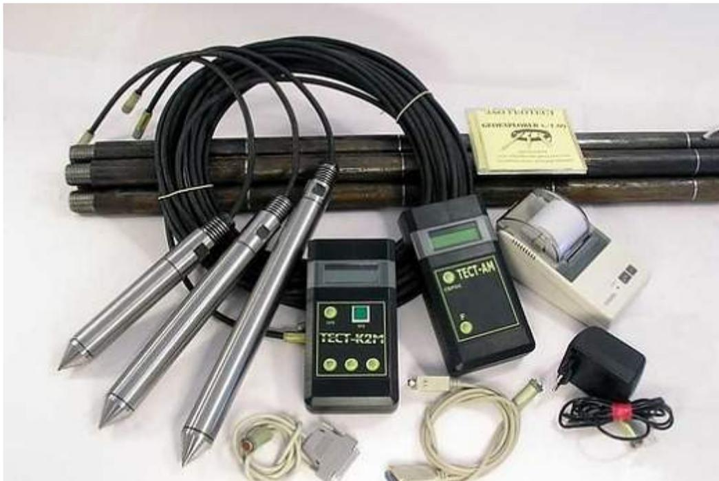
Рисунок 3.4.3.1– Комплект аппаратуры для статического зондирования грунтов
