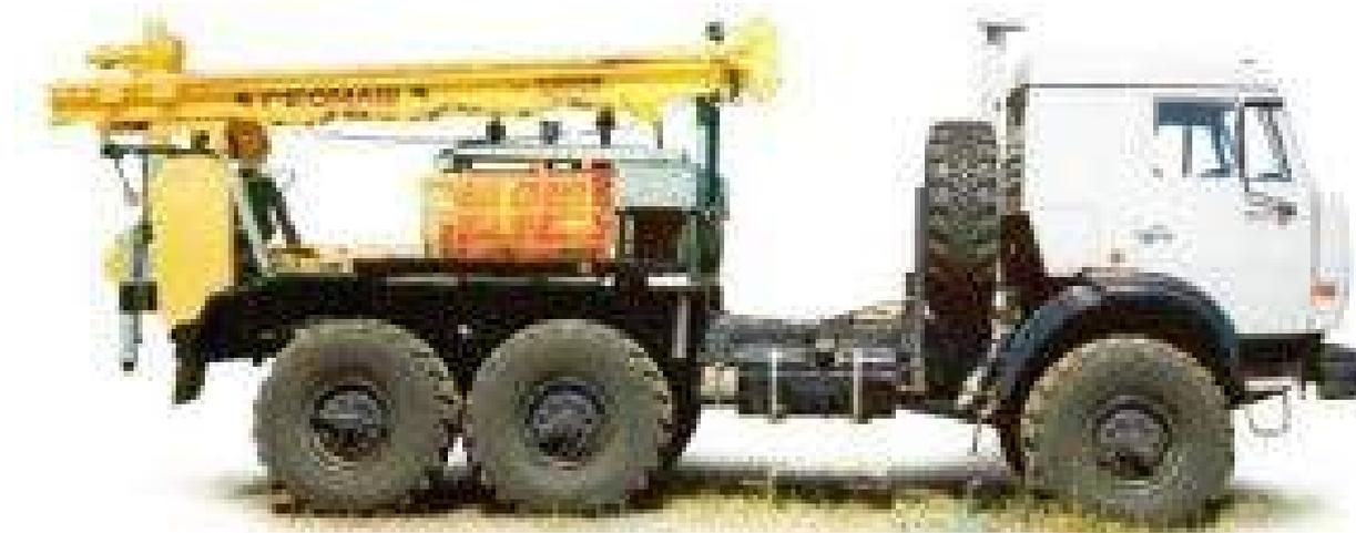
Рисунок 3.4.2.1–Буровая установка ПБУ-2 на базе автомобиля КАМАЗ.
