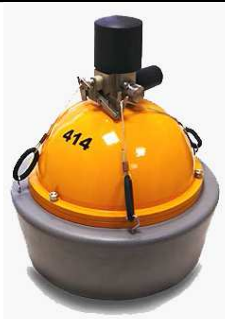
Рис. 1. донная станция компании ООО «Сейсмошельф»
