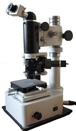
Рисунок 4.6 – Общий вид экспериментальной установки микротвердомера ПМТ-3 для измерения микротвёрдости
