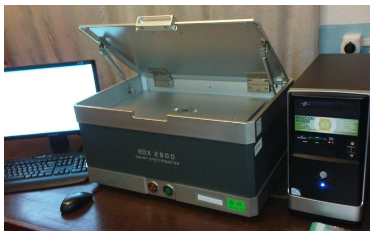
Рисунок 4.5 – Общий вид экспериментальной установки EDX 2800 EDXRF SPECTROMETER для спектрального анализа
