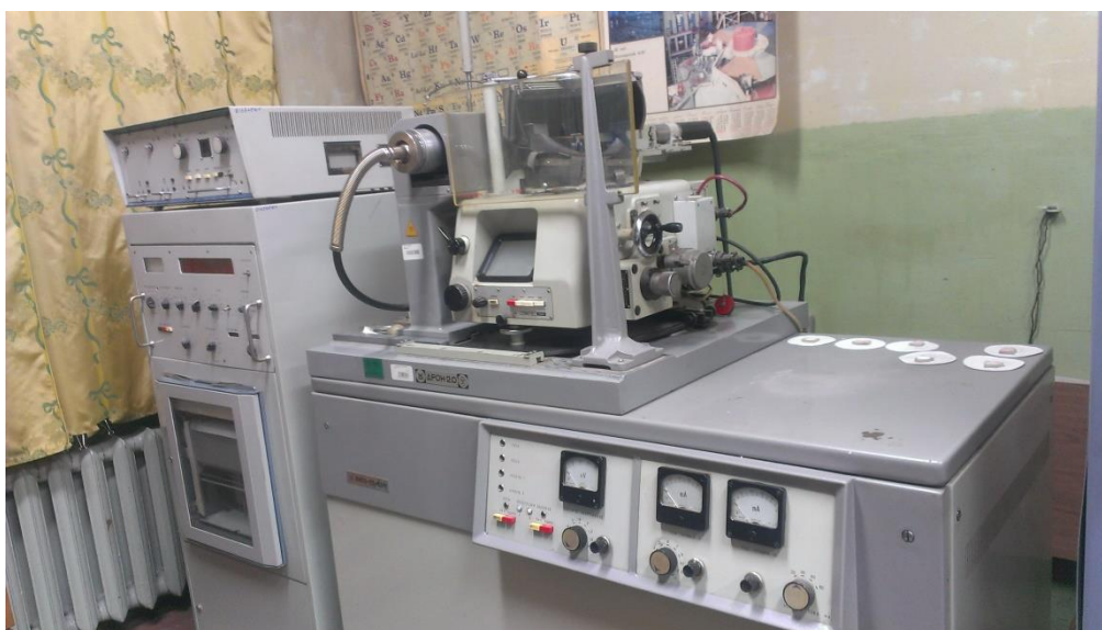
Рисунок 4.8 – Общий вид экспериментальной установки рентгеновский дифрактометр ДРОН-2.0
