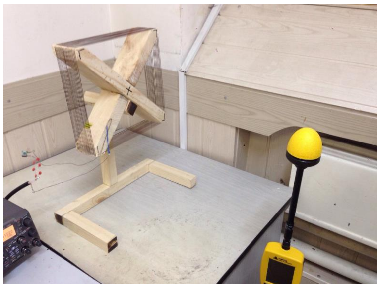
Рисунок 17 – Расположение катушки и измерителя для определения резонансной частоты первого контура
