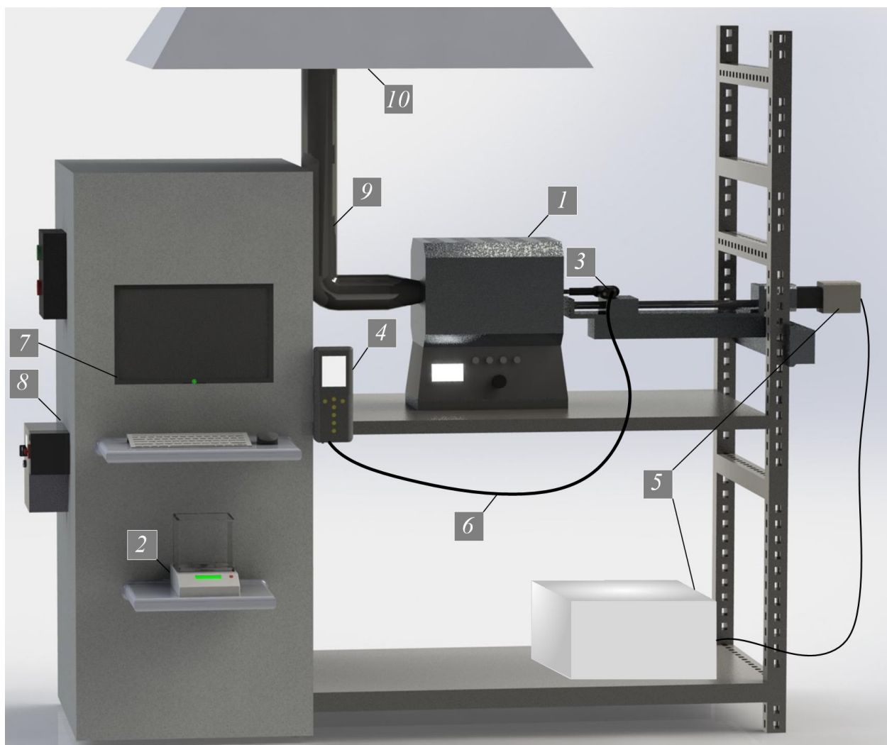
Рисунок 1.1 – Схема экспериментального стенда: 1 – муфельная печь; 2 – аналитические весы; 3 – модульный зонд; 4 – газоанализатор; 5 – координатный механизм; 6 – газоотборный шланг; 7 – персональный компьютер; 8 – пульт управления; 9 – воздуховод; 10 – вытяжная вентиляция
