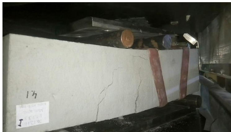
Рисунок 16 – Испытания железобетонной балки в процессе изгиба
