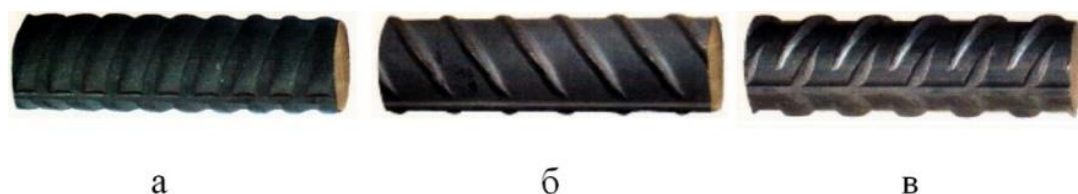
Рисунок 1 – Основные типы периодического профиля: а – кольцевой; б – серповидный двусторонний; в – серповидный четырехсторонний.
