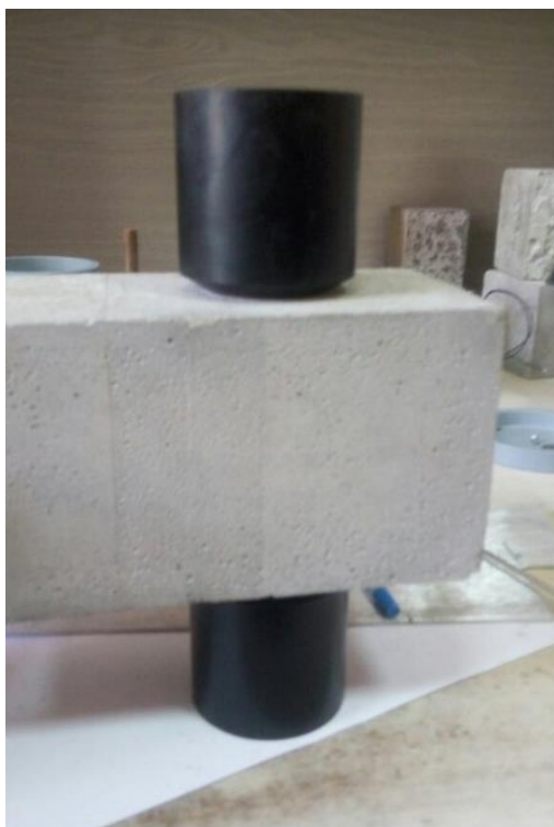
Рисунок 9 – Измерение скорости распространения ультразвука в образце
