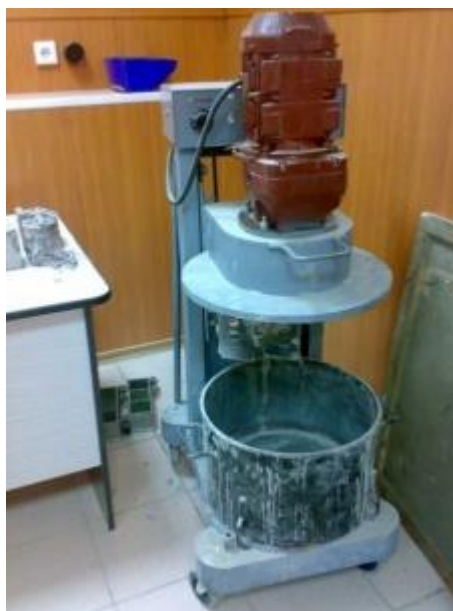
Рисунок 6 – Лабораторная мешалка МЛА-30
