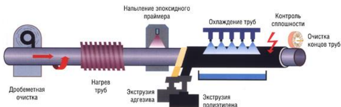
Рисунок 2.2 – Схема заводской изоляции труб
