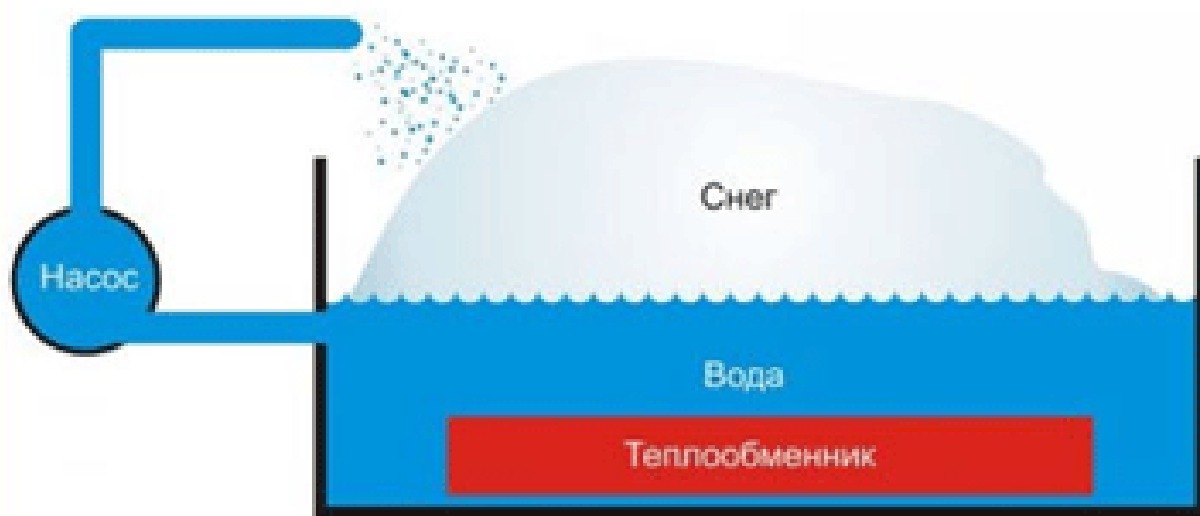
Рисунок 18 – Принцип работы снегоплавильной установки
