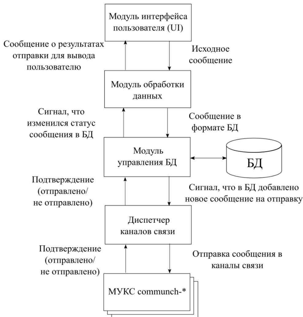
Рисунок 20 — Схема процесса обработки сообщения, введенного пользователем для передачи по каналам связи
