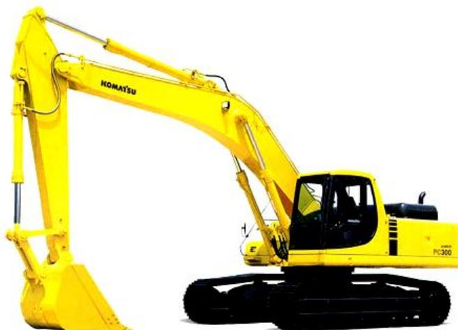
Рисунок 26а – одноковшовый экскаватор KOMATSU PC300-7
