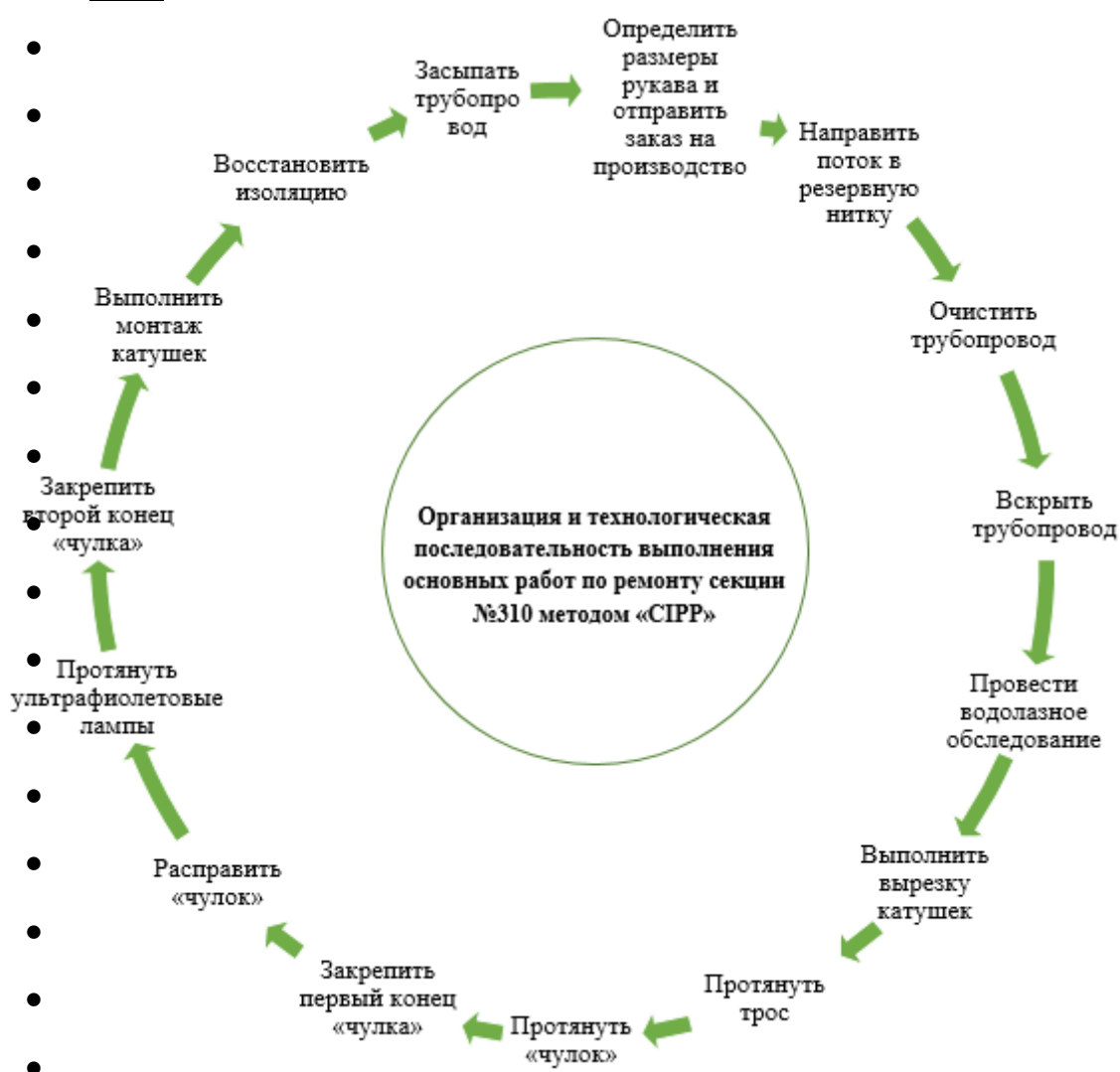
Рисунок 16 – Алгоритм ремонта трубопровода с применением технологии [REDACTED]
