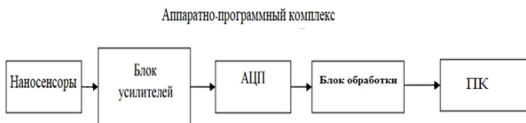
Рисунок 13 - Структурная схема АПК
