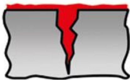
Рисунок 2 – Нанесение индикаторной жидкости (пенетранта)
