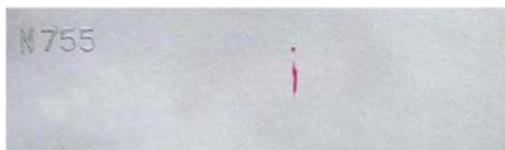
Рисунок 7 – Контрольный образец с индикаторным следом
