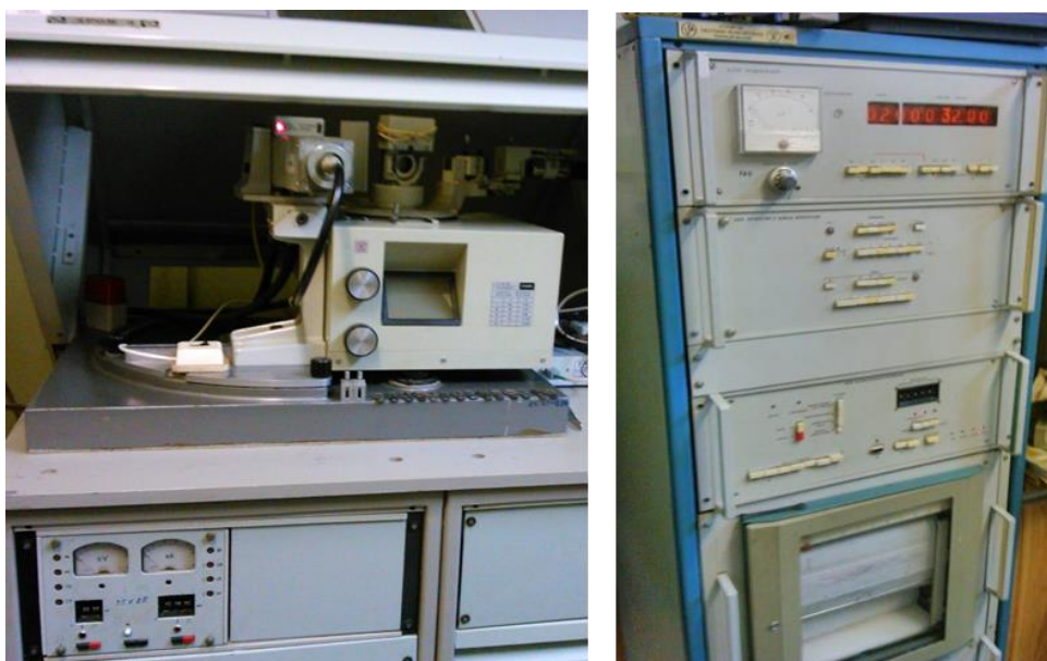
Рис. 16 Рентгеновский дифрактометр ДРОН – 3,0
