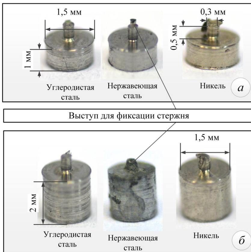
Рис. 2.1.4 – Металлические включения цилиндрической формы: а – включения размером 1 мм; б – включения размером 2 мм
