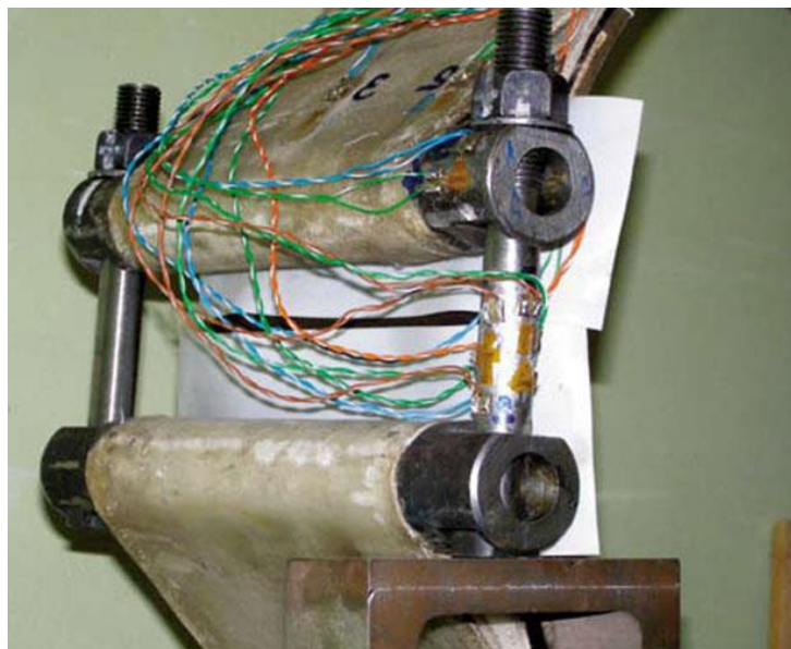
Рисунок 5 - Узел затяжки муфты РСМ-530 [10]
