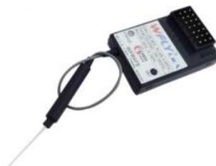
Рисунок 18 – Приемник WFR07S
