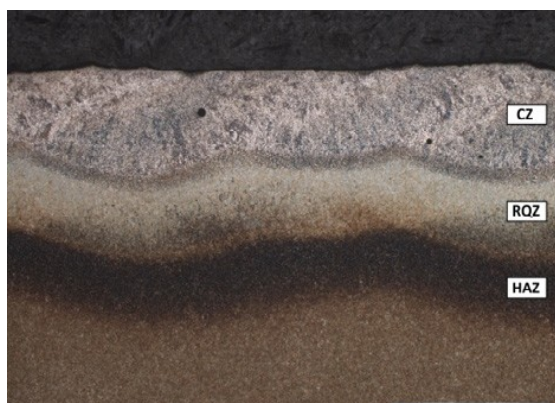
Рисунок 6. Зоны воздействия основного металла с наплавленным.
