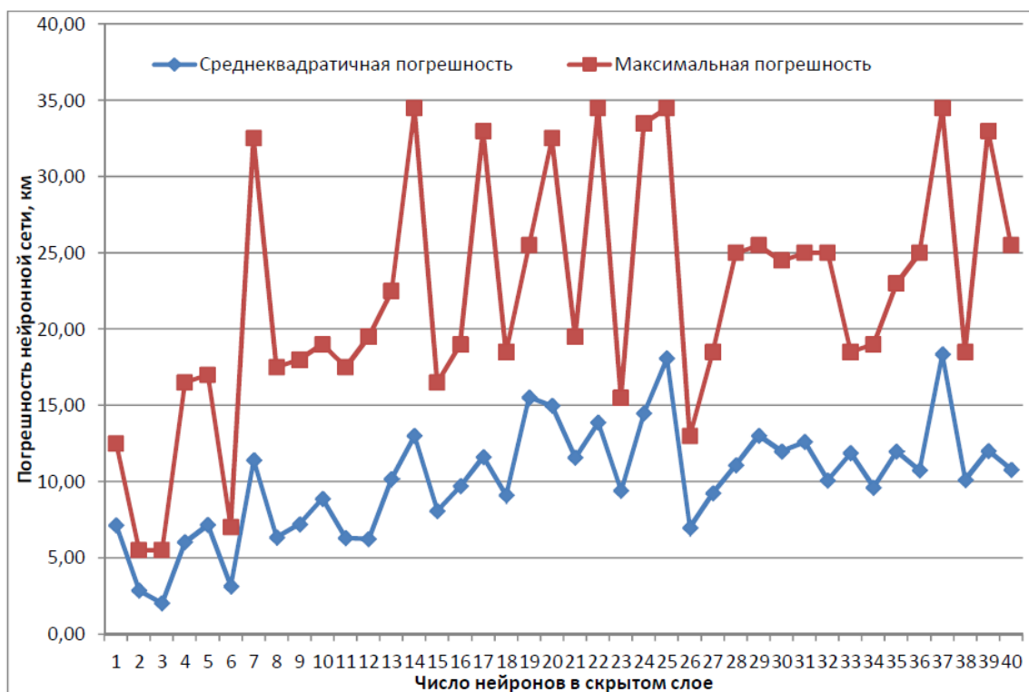
Рисунок 2.19 – График зависимости среднеквадратичной и максимальной погрешности от числа нейронов в скрытом слое многослойного персептрона
