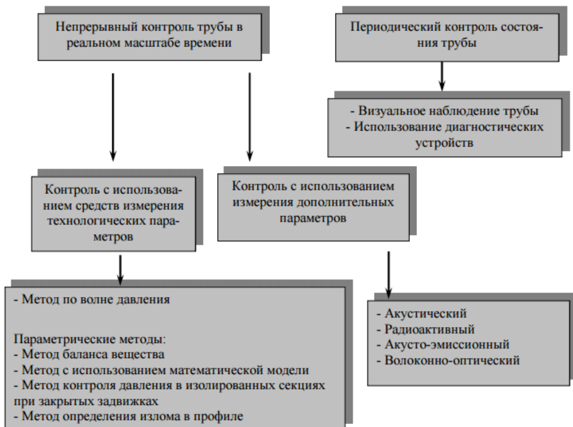
Рисунок 1.1 – Классификация СОУ по принципам действия и типам применяемого оборудования
