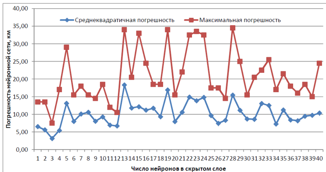
Рисунок 2.22 – График зависимости среднеквадратичной и максимальной погрешности от числа нейронов в скрытом слое каскадной сети
