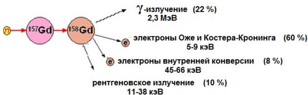
Рисунок 1.2 – реакция захвата тепловых нейтронов атомами ^{157}\text{Gd}
