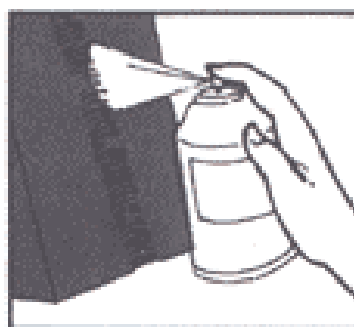
Рисунок 3 – Предварительная очистка поверхности
