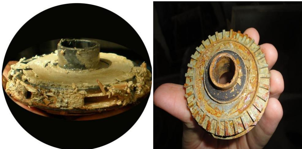
Рисунок 16 - Отложения солей на рабочем колесе электроцентробежного насоса
