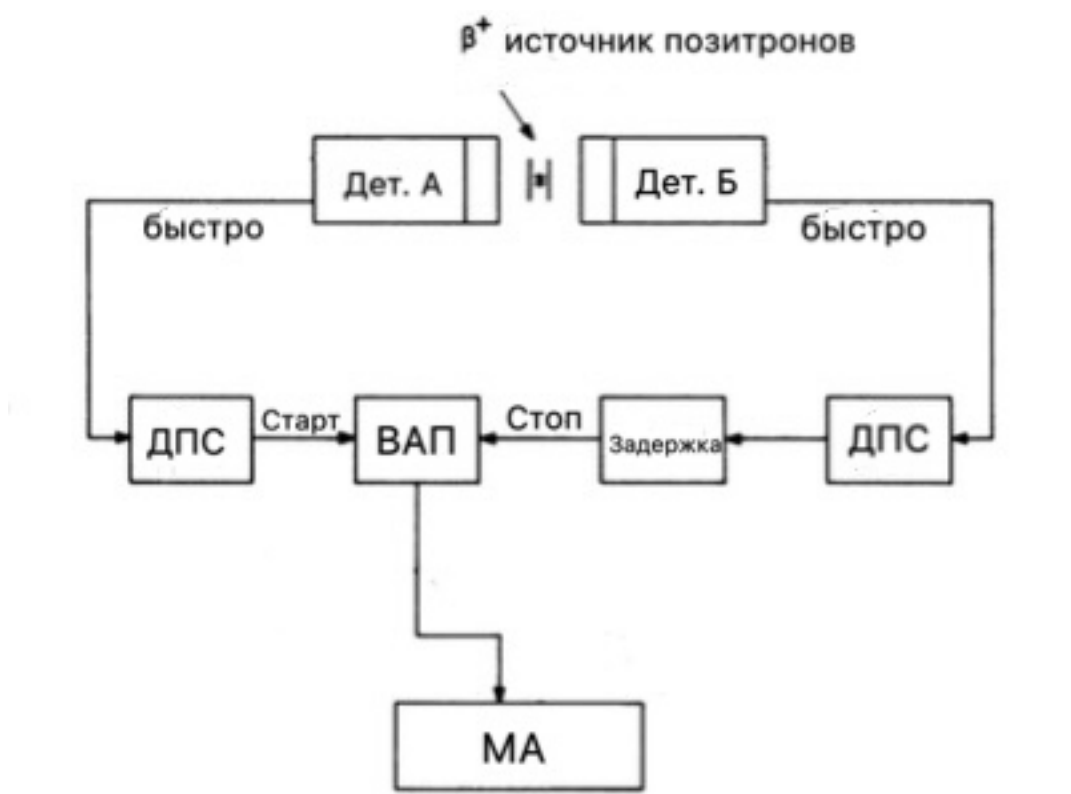
Рис.4 Спектрометр для измерения времени жизни позитронов. ВАП: время-амплитудный преобразователь; ДПС: дискриминатор постоянной составляющей; МА: многоканальный анализатор
