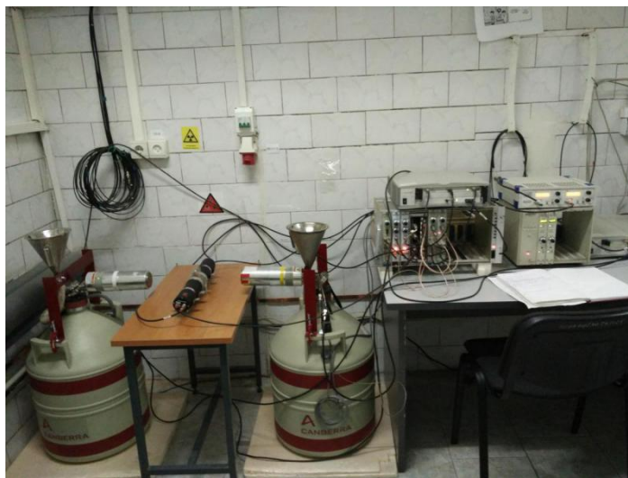
Рисунок 6 – Внешний вид цифрового модуля по распределению времени аннигиляции позитронов (лаборатория НЗ, 3 корпус ТПУ)
