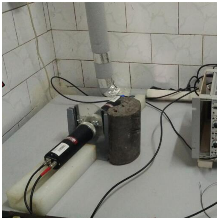
Рисунок 14 – Положение свинца для защиты радиоактивного излучения
