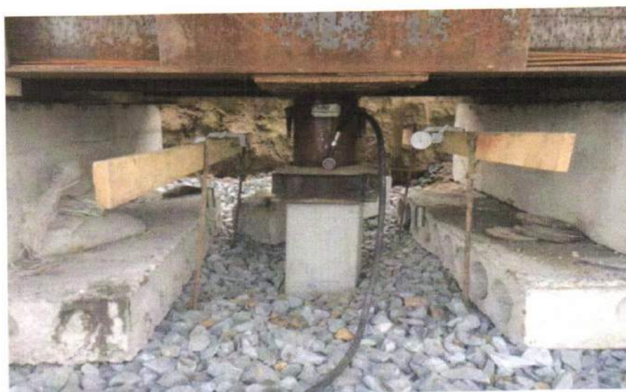
Рис. 3.15. Прогибомер Максимова ИЧ-10 и гидравлический домкрат ДГ-100
