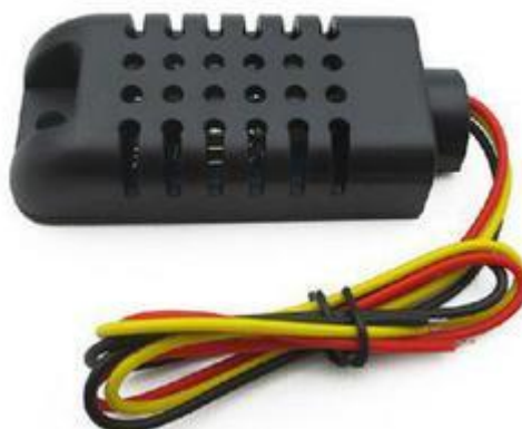
Рисунок 3 - Датчик влажности и температуры окружающей среды AM2301
