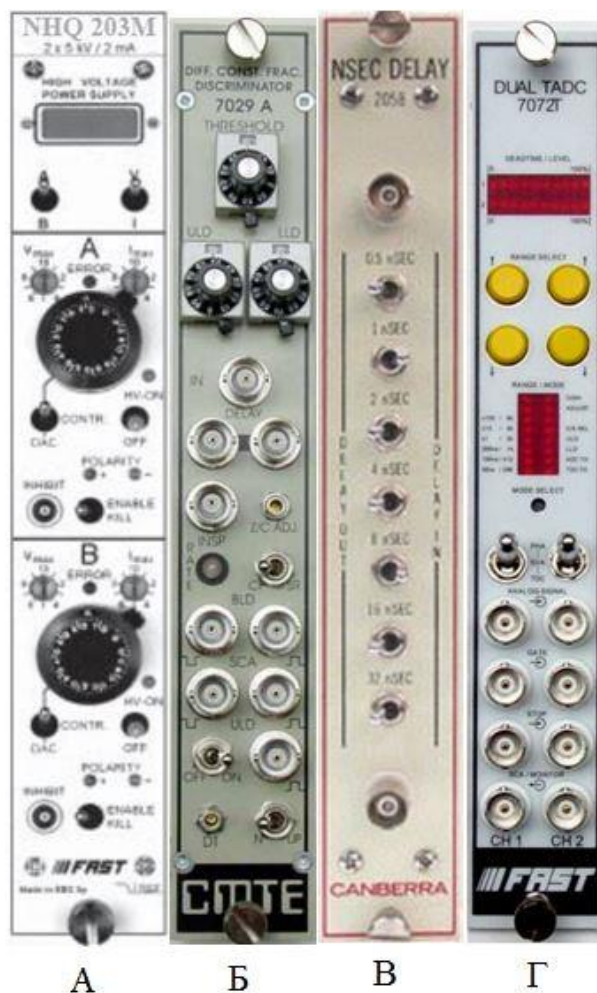
Рисунок 8 – Устройство спектрометра: А – высоковольтный источник питания, Б – дифференциальный дискриминатор, В – блок наносекундной задержки, Г – время-цифровой преобразователь.
