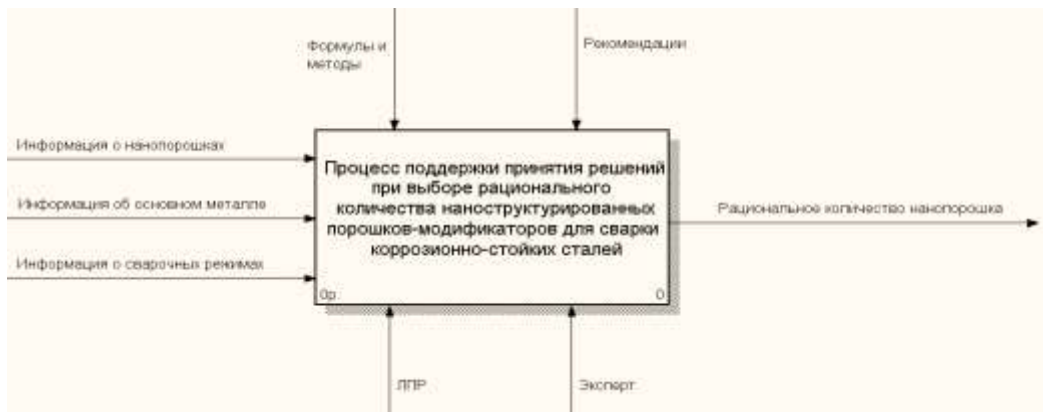
Рисунок 2.2 – Диаграмма IDEF0 «Процесс поддержки принятия решений при выборе рационального количества наноструктурированных порошков-модификаторов для сварки коррозионно-стойких сталей»
