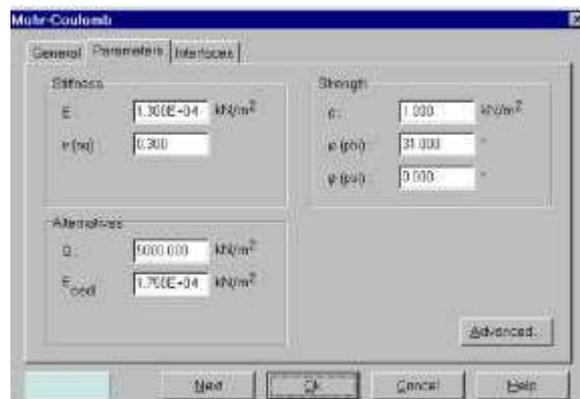
Рисунок 3.19. Вкладка Parameters (Параметры) окна набора данных по грунту и контактным поверхностям
