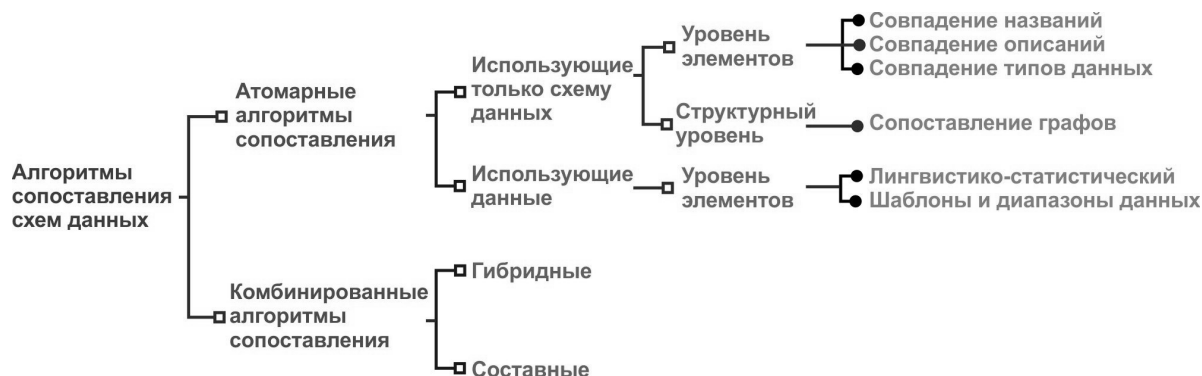
Рис. 2. Классификация алгоритмов, используемых для сопоставления схем данных
