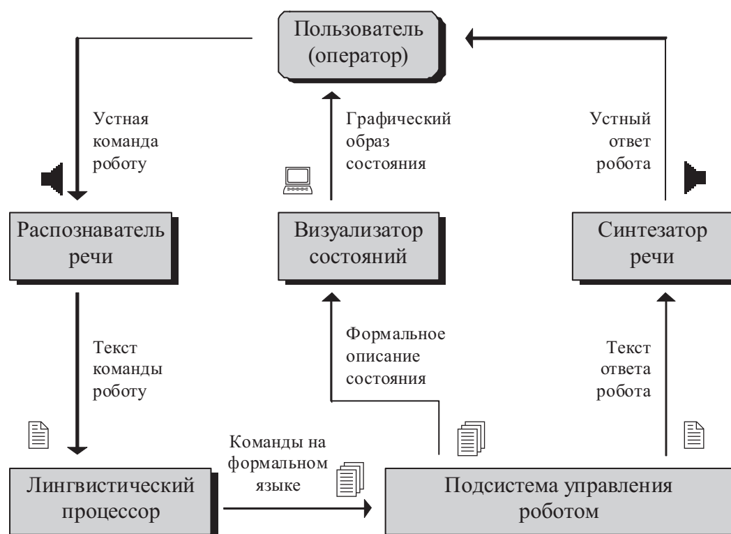
Рис. 1. Функциональная схема системы речевого управления роботом
