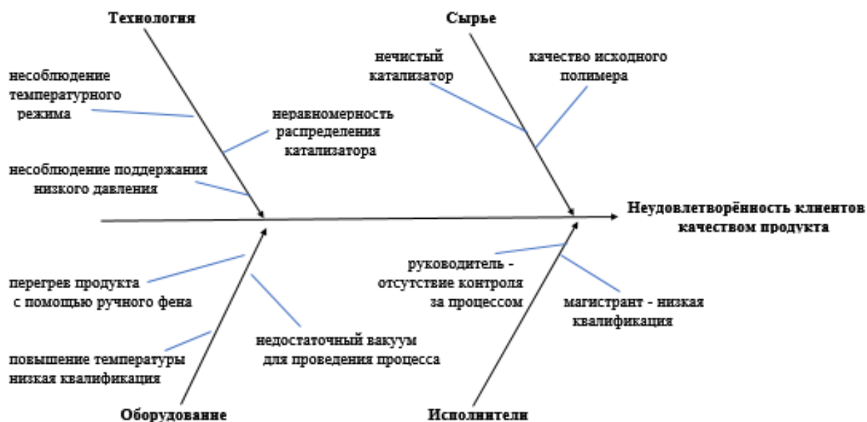
Рисунок 17 – Причинно-следственная диаграмма низкого выхода лактида при проведении деполимеризации полилактида
