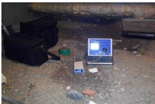
Рисунок 10-11 – Измерение ППР в подвале строящегося дома с помощью комплекса «Альфарад плюс АРП»
