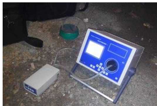
Рисунок 10-11 – Измерение ППР в подвале строящегося дома с помощью комплекса «Альфарад плюс АРП»
