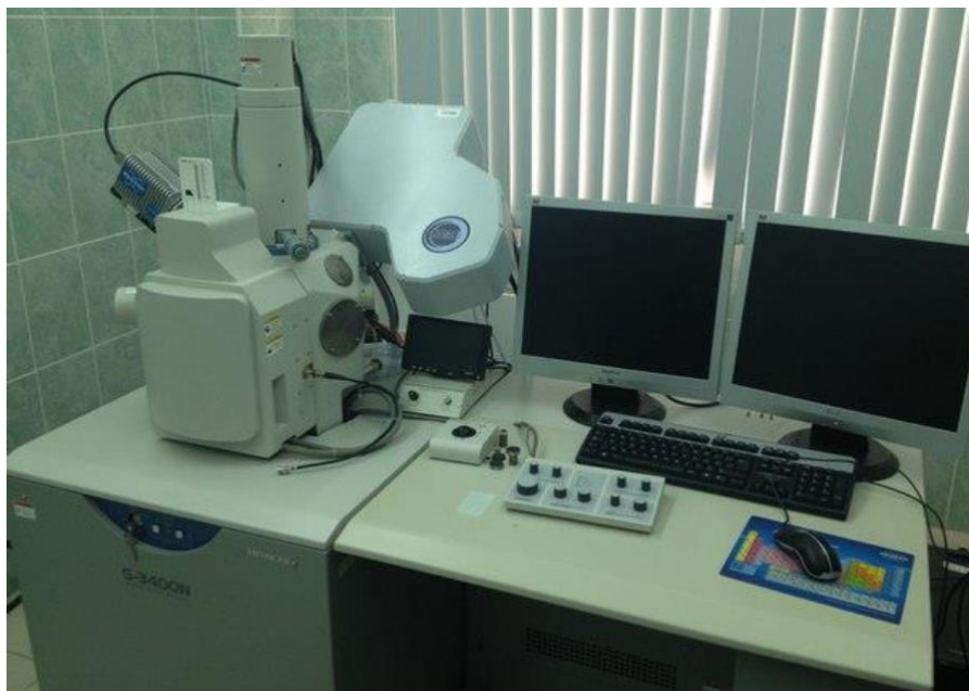
Рисунок 2 - Сканирующий электронный микроскоп НІТАСНІ S-3400N с энергодисперсионным спектрометром Bruker X Flash 4010.
