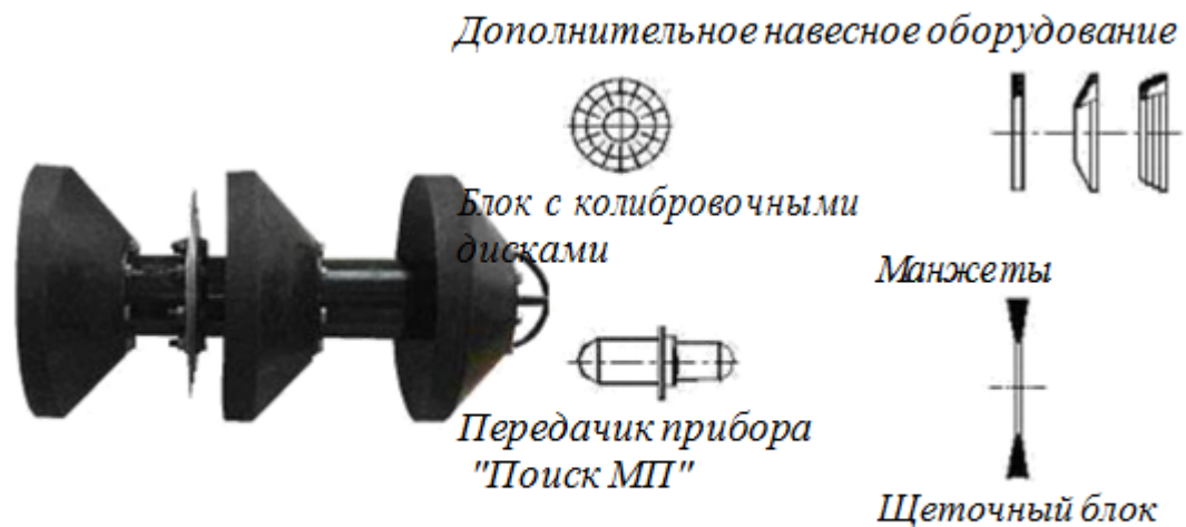
Рисунок 8 – Скребки, поршни (Устройства очистные) с резиновыми конусными манжетами "ОУ-КР"
