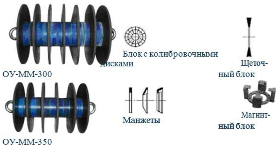
Рисунок 9 – Скребки, поршни (устройства очистные) многоманжетные "ОУ-ММ"
