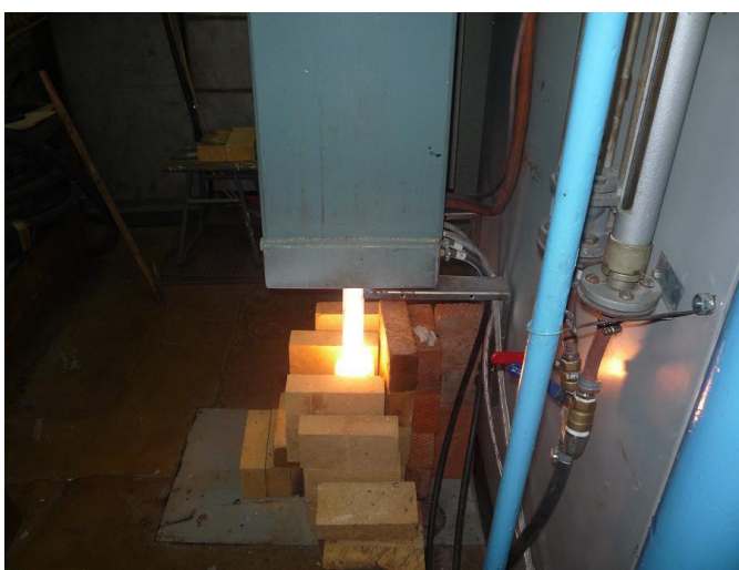
Рисунок 3.4 – Тигель с модельным составом ОП ОЯТ в виде ВСОК-2 под воздушной плазменной струей ВЧФ-плазмотрона.
