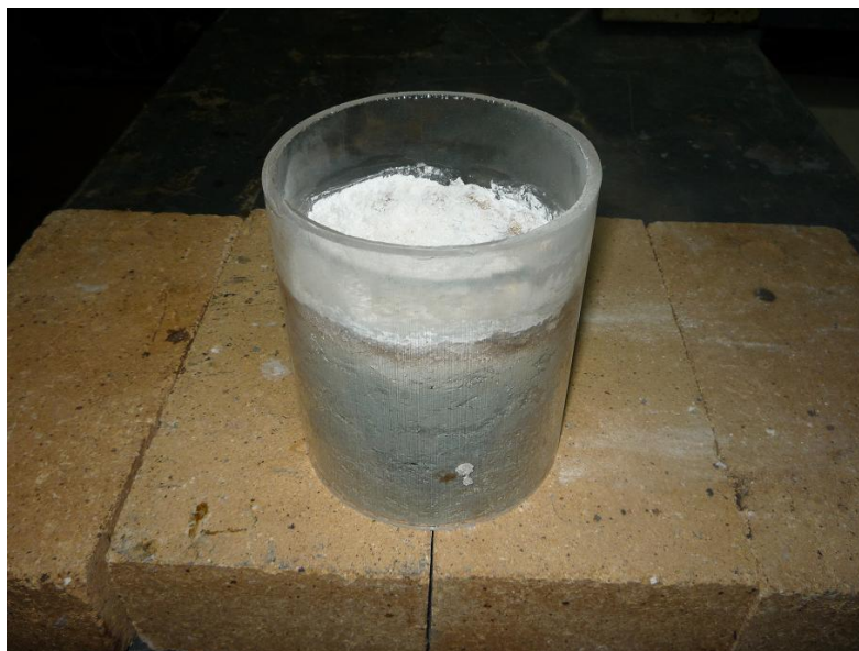
Рисунок 3.5 – Внешний вид расплава хлорида натрия после плазменной иммобилизации модельных ОП ОЯТ
