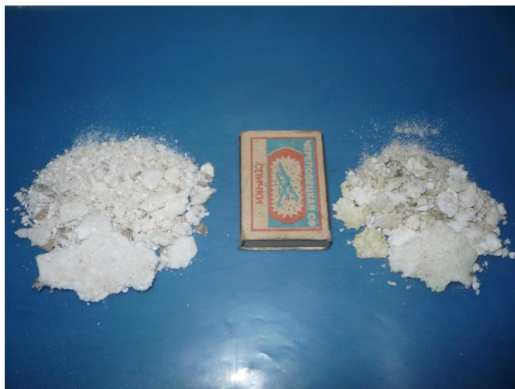
Рис. 3.6 – Внешний вид застывшего расплава хлорида натрия после плазменной иммобилизации модельных ОП ОЯТ
