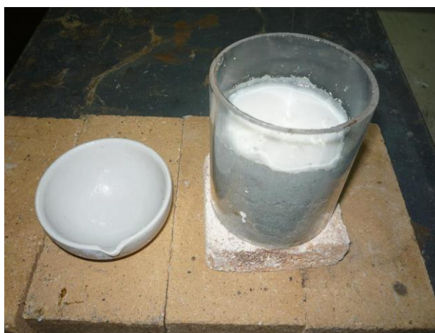
Рисунок 3.3 – Тигель с модельным составом ОП ОЯТ в виде ВСОК-2
