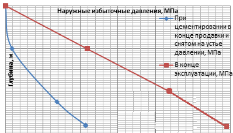
Рисунок 2.7 – Эпюра наружных избыточных давлений
