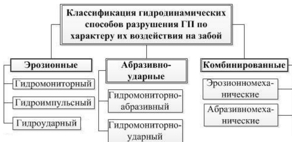
Рисунок 1 – Классификация гидродинамических способов разрушения горных пород по характеру их воздействия на забой
