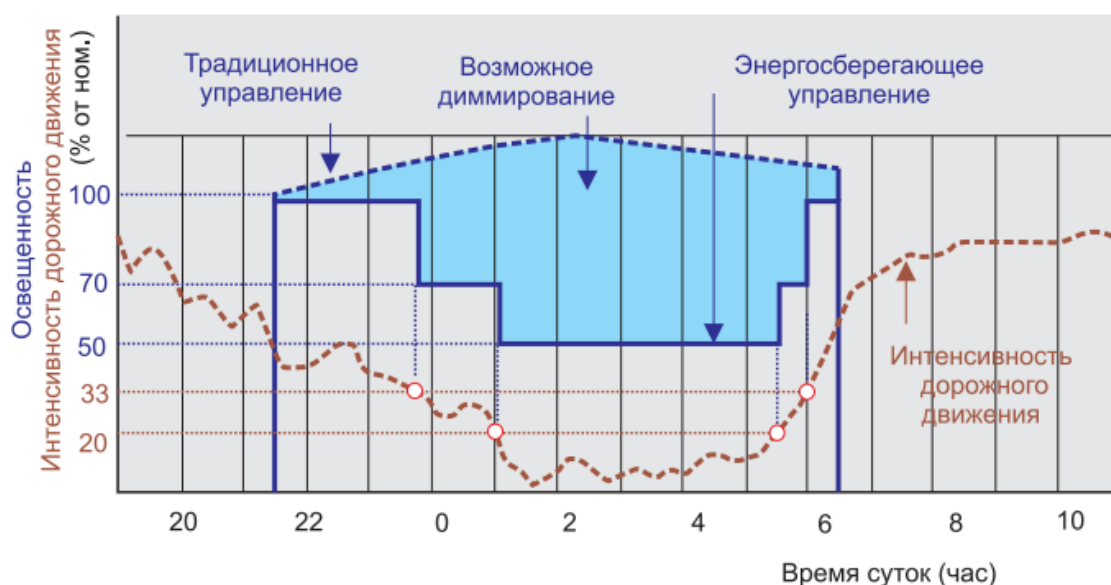
Рисунок 4 - Диммирование в зависимости от интенсивности движения транспорта
