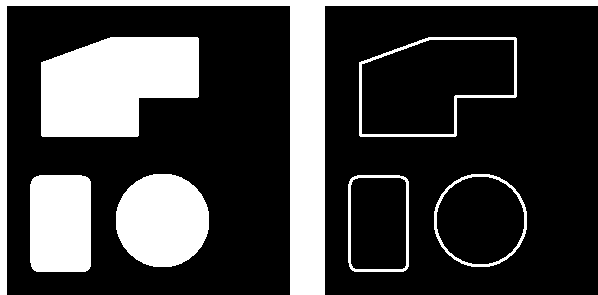
Рисунок 7 – Пример получения границы методом выделения границ
