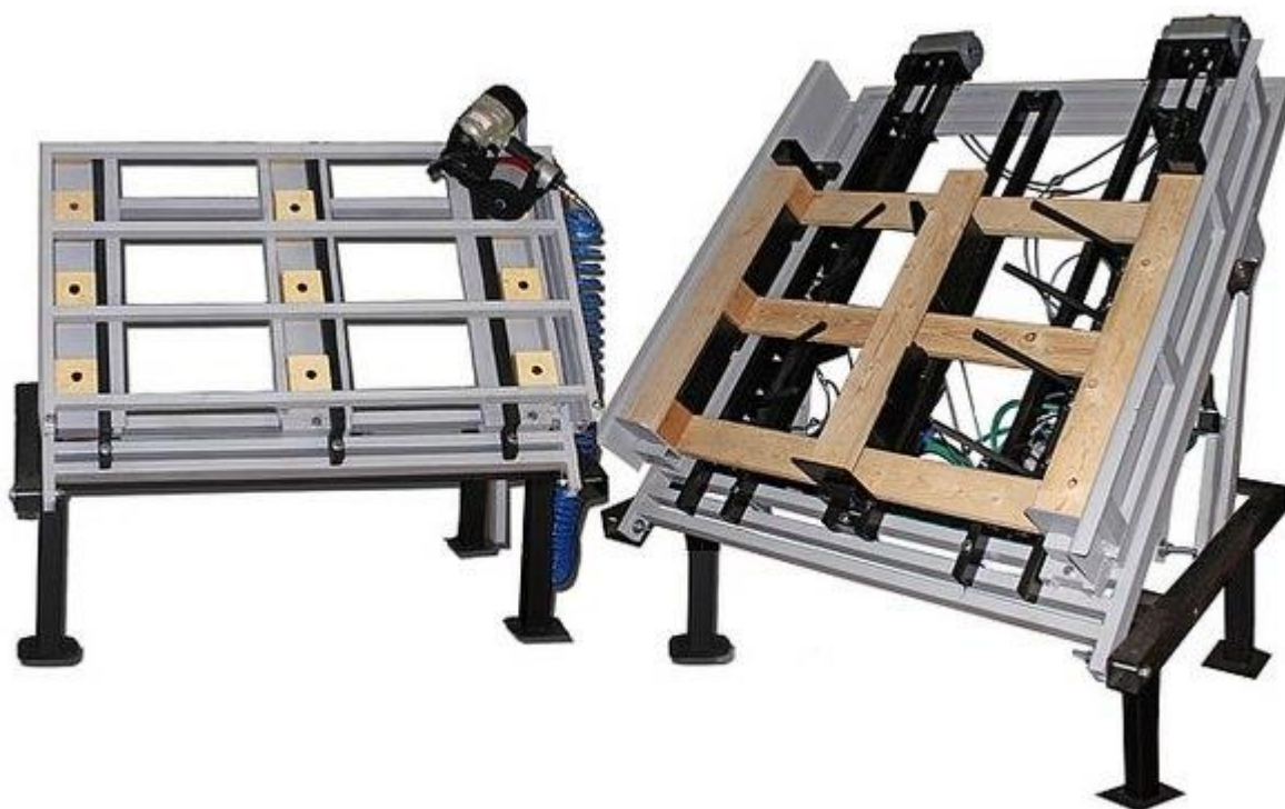
Рисунок 1 – Монтажный стол для сборки деревянных поддонов
