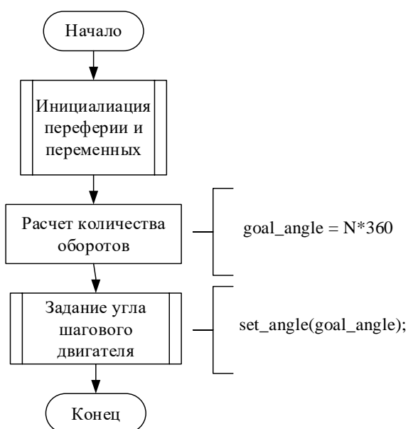
Рисунок 38 – Блок-схема алгоритма главной функции логического контроллера нижнего уровня
