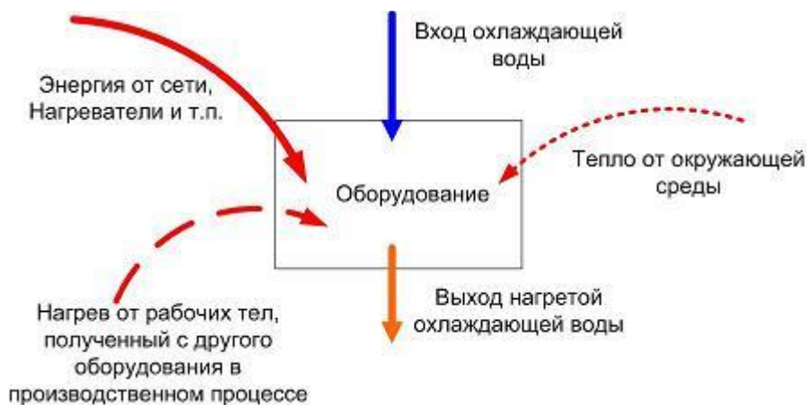
Рис. 1.7. Схема расчета количества тепла, которое необходимо отводить от охлаждаемого оборудования
