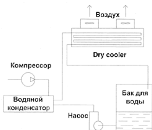
Рис.1.8. Схема системы «Dry cooler»
