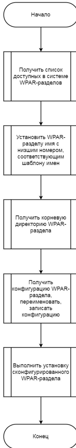
Рисунок 4 – Блок-схема процесса выключения WPAR-раздела
