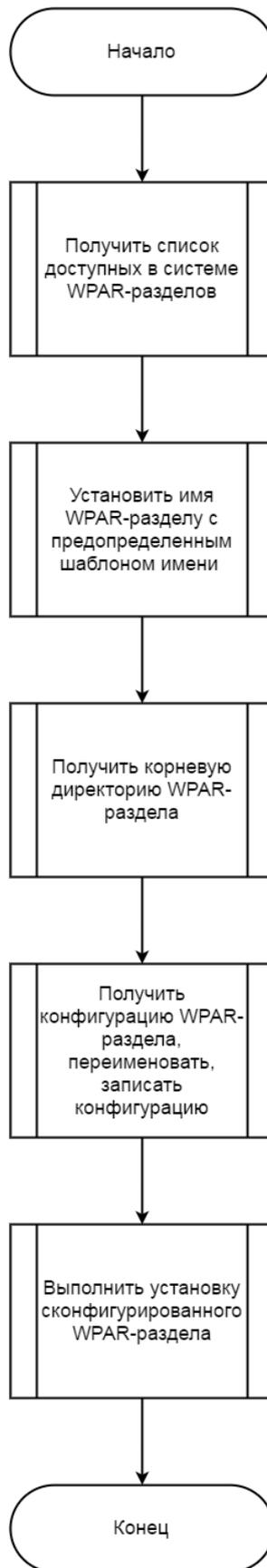
Рисунок 3 – Блок-схема процесса включения WPAR-раздела
