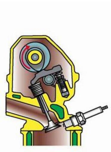
Рисунок 9. Газораспределительная система ДВС
